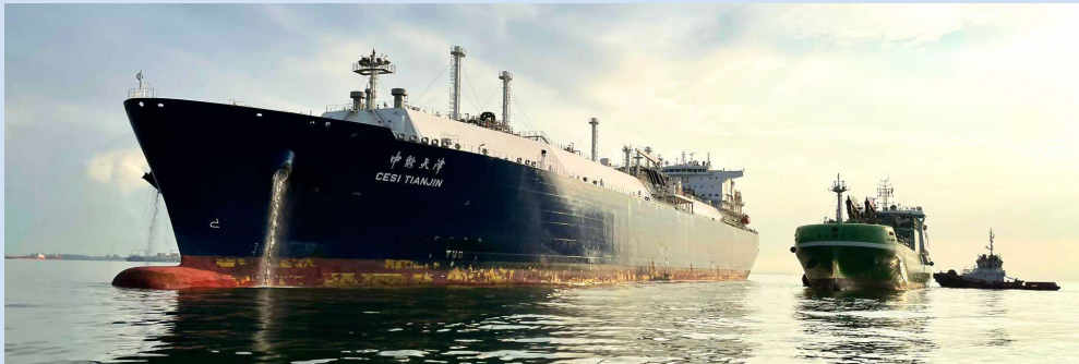
LNG being transferred from a large LNG carrier to a smaller LNG bunkering vessel
