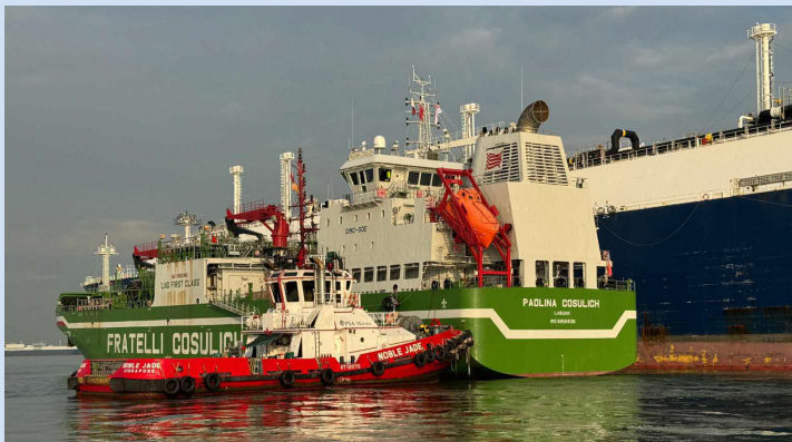
LNG being transferred from a large LNG carrier to a smaller LNG bunkering vessel
