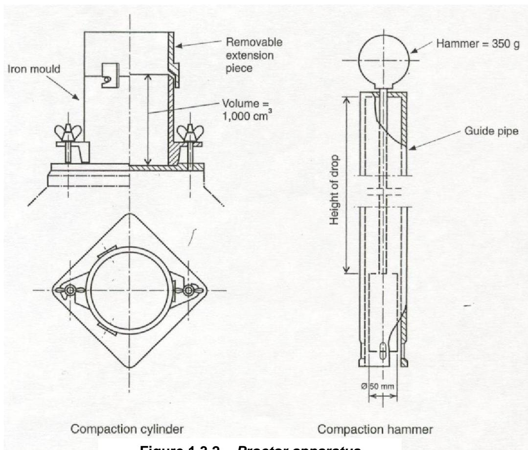
**Figure 1.3.2 – Proctor apparatus**
